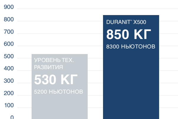
Прочность при сжатии 3/4 дюйма DURANIT® X500 (среднее значение в кг)
